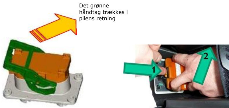
Et eksempel på udtagning af sikkerhedsafbryderen i Opel til venstre og Renault til højre.
