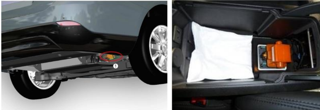
Sikkerhedsafbryder placeret bag højre baghjul på en Renault og mellem forsæderne på Opel.
